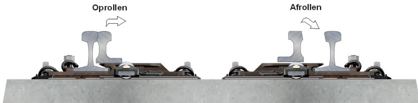
Afbeelding 2: Links de aanliggende tong, rechts de aflaggende tong t.o.v. de Austroroll
